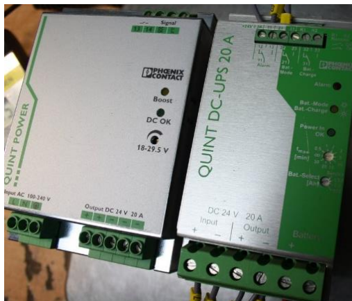
Nät-del laddare till höger, till vänstre DC/DC med 24V ut
